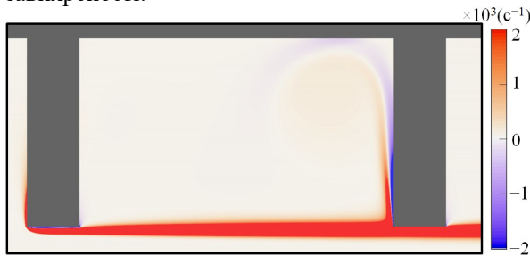
Рис. 2. Поле завихреності при Re \approx 1973
