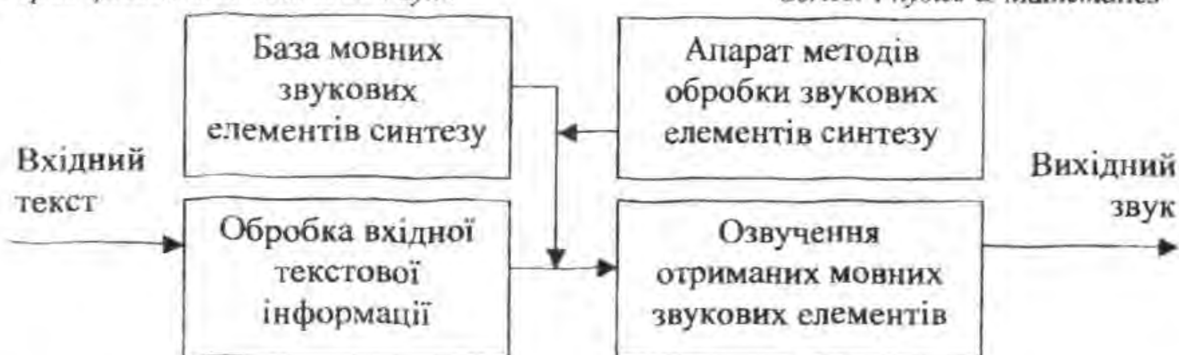
Рис. 1. Загальна схема роботи системи TTS синтезу.
