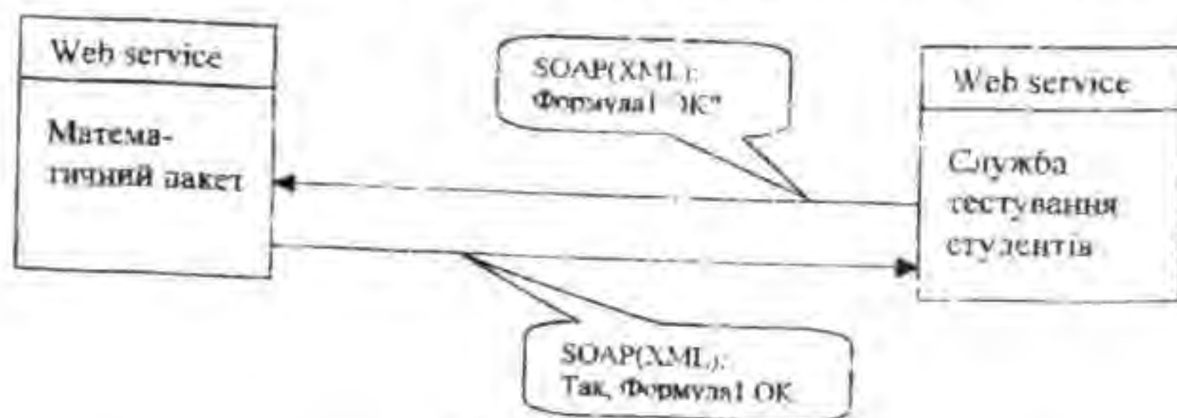
Малюнок 1. Приклад взаємодії двох систем, що використовують технологію Web-служб
