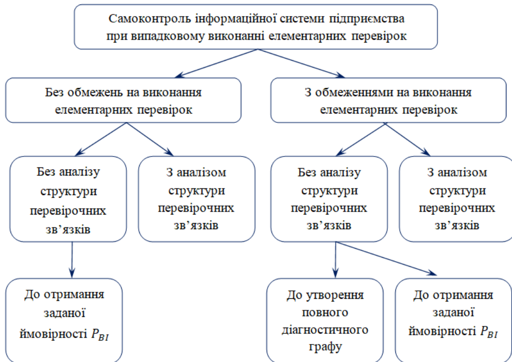
Рис. 1. Метод самодіагностування інформаційної системи підприємства при випадковому виконанні елементарних перевірок
