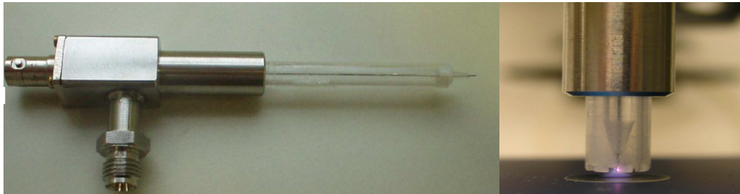
Рис.4 (зліва) "Плазмова голка". (праворуч) Плазма з плазмової голки розширюється до субстрату
