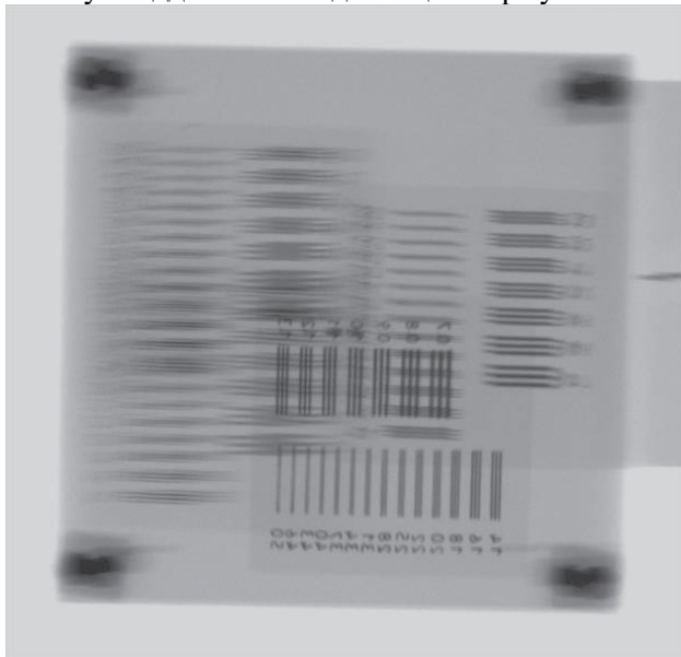
Рис. 3: Приклад зрізу фантому отриманого за допомогою цифрової ламінографії.
