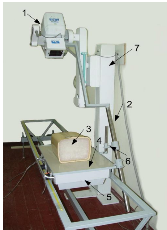
Рис. 2. Експериментальна установка для томосинтезу.. Джерело рентгенівського випромінювання (1), вісь що синхронізує рух детектора та джерела (2), фантом (3), стіл (4), цифровий детектор рентгенівського випромінювання (5), вісь обертання системи (6), рухома опора (7).
