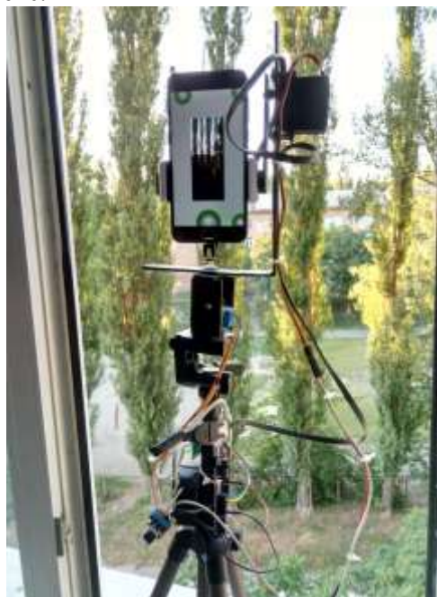
Рис. 2 Апаратний комплекс для автоматичної зміни положення камери у просторі
