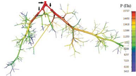
Рис. 4. Розподілення артеріального тиску в моделі системи коронарних артерій людини
