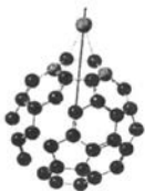
Рис. 1. Комплекс молекули C_{60} з атомом олова C_{60} -Sn(6,6). Стрілка вказує напрям та величину дипольного моменту. Контраст атомів вуглецю молекули відповідає різним знакам та величинам розподіленого заряду.
