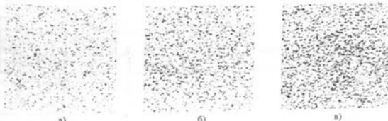
Рис. 1 Руїнування просторової когерентності для системи з багаторазовим розсіюванням: один розсіюючий шар (а), 4 розсіюючих шари (б) та 8 розсіюючих шарів (в).
