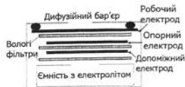
Рис. 3 Конструкція електрохімічного сенсора
