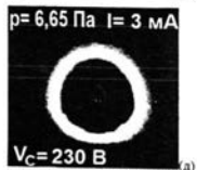
Рис.6. Порівняння фотографій розряду над катодом МРПІ без мішені при тиску баластного газу p = 1,33\text{ Па} (а, в) та p = 6,65\text{ Па} (д) з результатами комп'ютерного моделювання (б, г, е).
