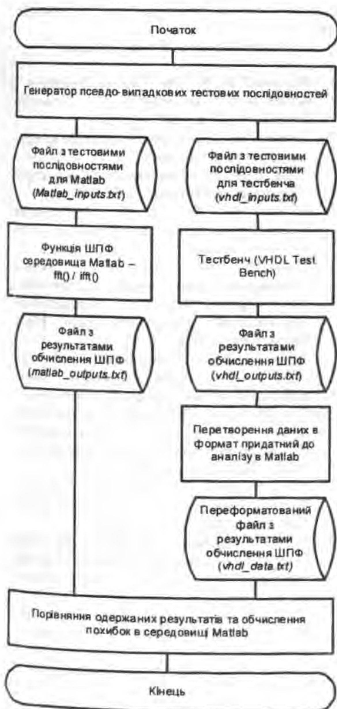
Рис. 1. Алгоритм автоматизованої верифікації синтезованих VHDL-моделей АОП ШПФ з фіксованою комою
