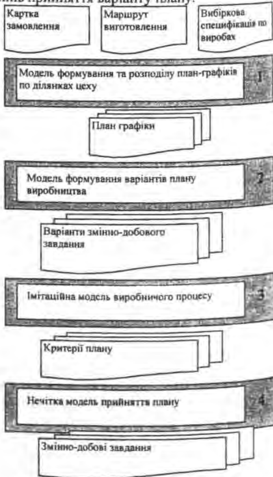
Рис. 2. Гібридна модель нечіткого ситуаційного планування та моделювання виробництва
