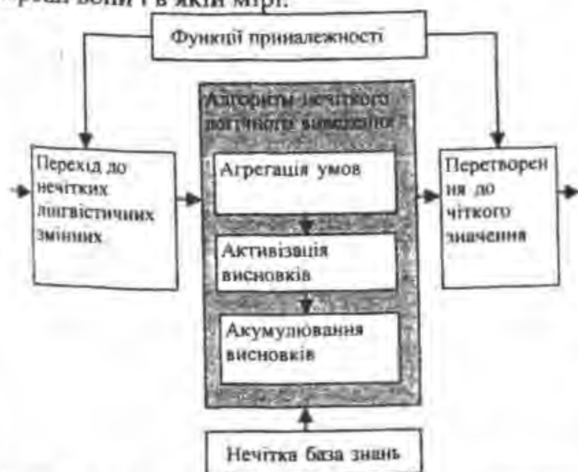
Рис. 3. Архітектура нечіткої моделі прийняття плану
