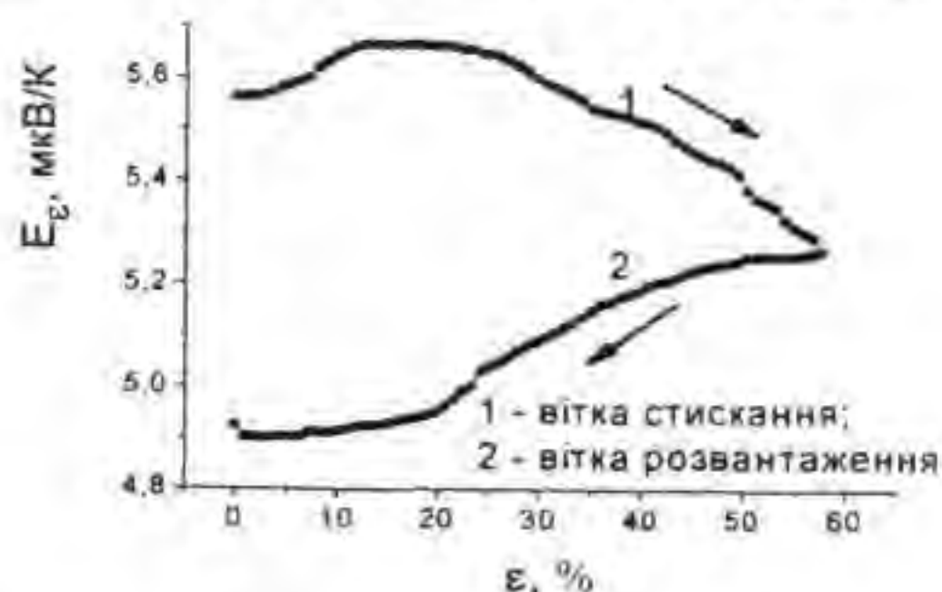
Рис. 4. Залежність термо-е.р.с. E_e від деформації стискання \epsilon насипного порошку «Sorbex».
