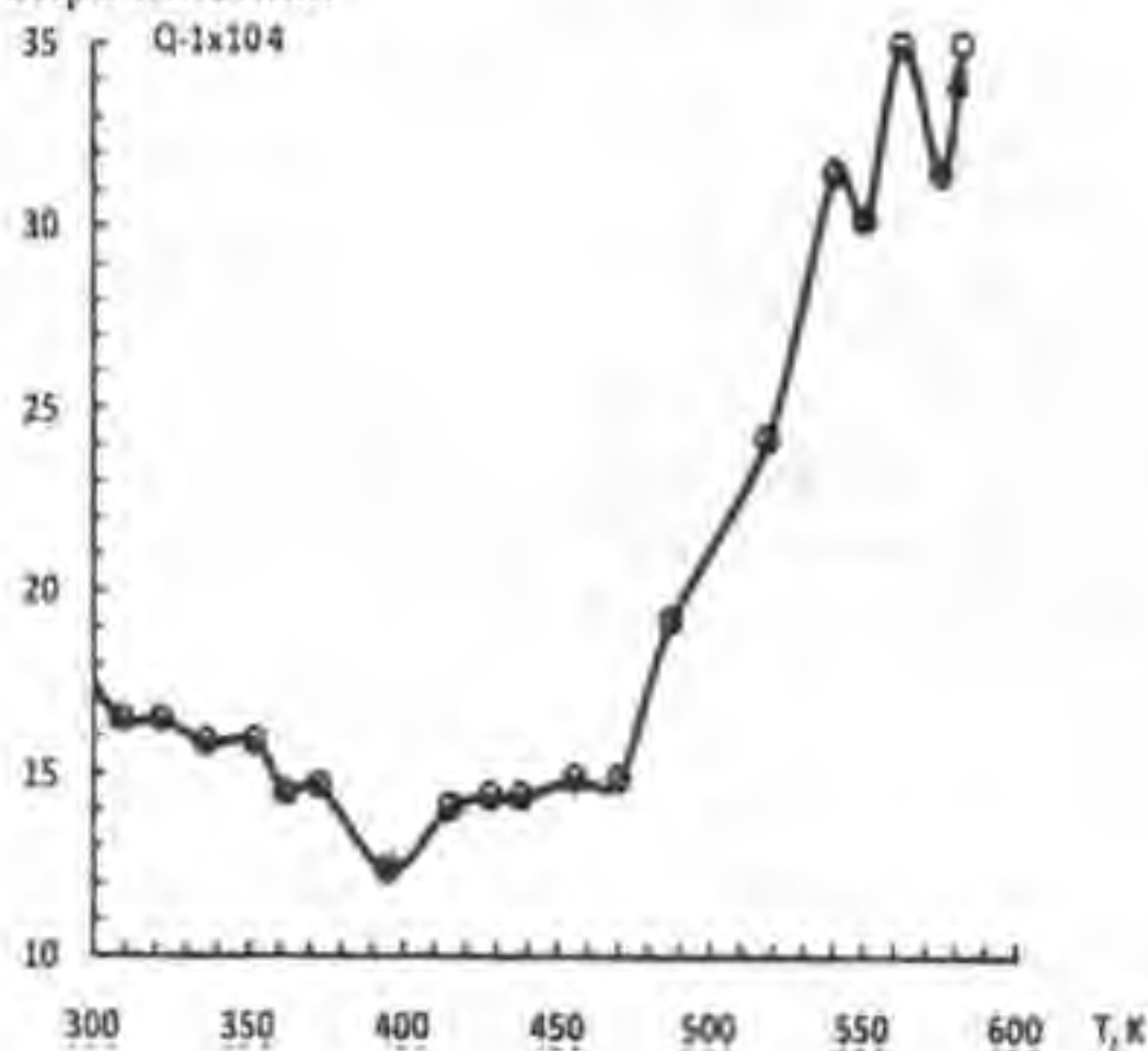
Рис. 1. Температурна залежність внутрішнього тертя Q^{-1} сплаву Ag_{0.8}Zn_{0.2} після електронного опромінення флюенсом \Phi \approx 5 \cdot 10^{17} \text{ см}^{-2} .
