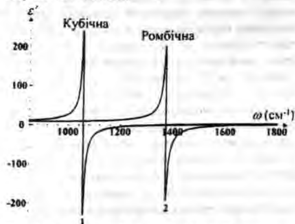
Рис. 3. Дисперсійні залежності \varepsilon'(\omega) для модифікації BN, що належать до кубічної (1) та ромбічної (2) сингоній (орієнтація k \parallel C ).
