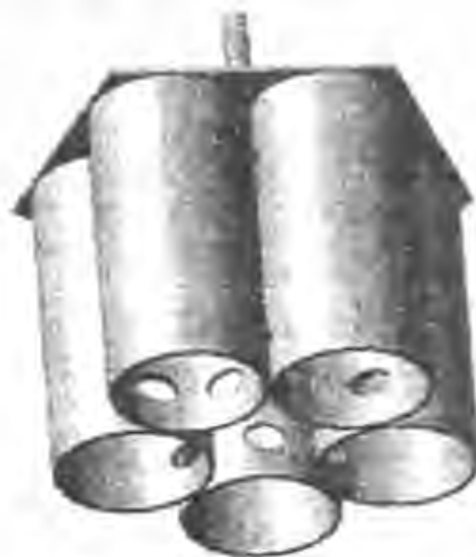
Рис. 2. Конструкція блока зв'язаних порожнинних катодів.
