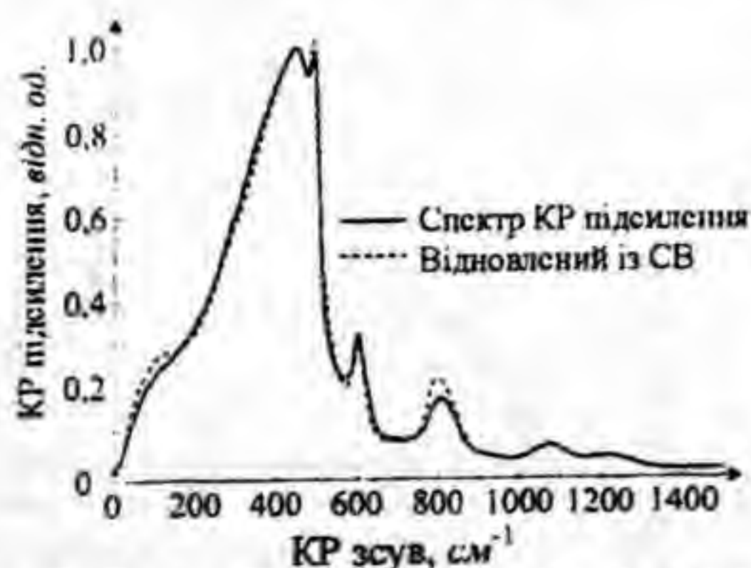
Рис.3. Спектр КР підсилення з [12] (суцільна лінія) та відновлений спектр підсилення із спектра спонтанного випромінювання (СВ) КР (штрихова лінія), показаний на рис.2. Обидва спектри нормовані на одиницю у максимумі КР на 440\text{ см}^{-1} .
