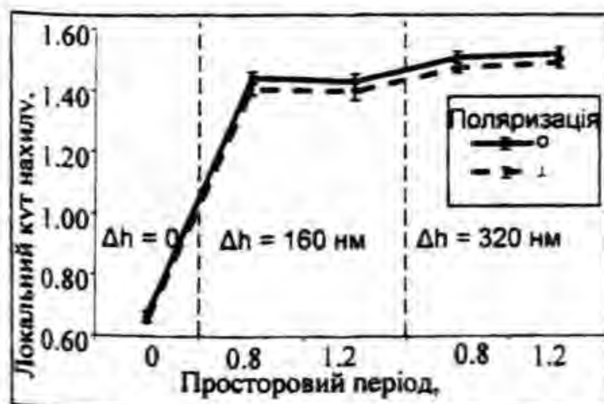
Рис. 5 Значення локального нахилу хвильового фронту для двох ортогональних поляризацій.
