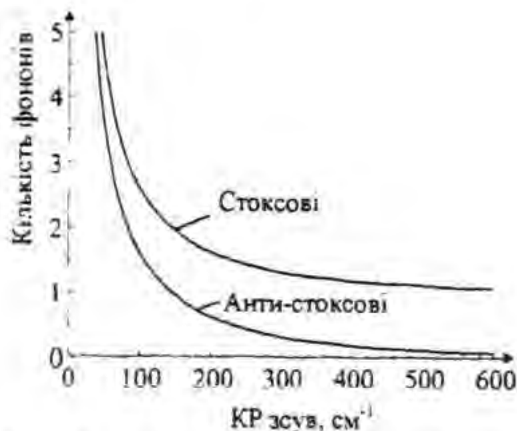
Рис.1. Залежність фононної щільності від хвильового числа КР зсуву як для стоксового, так і для анти-стоксового фотонів при T=300\text{K}
