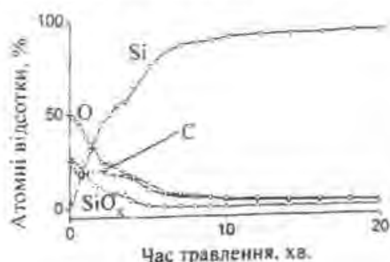
Рис. 3. Концентраційні профілі елементів по глибині наноструктурованої плівки ps-Si.
