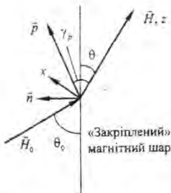
Рис. 2 Границя «вільного» магнітного шару (ліворуч) та «закріпленого» магнітного шару (праворуч). Вектор \vec{p} визначає напрямок протікання спин-поляризованого струму.
