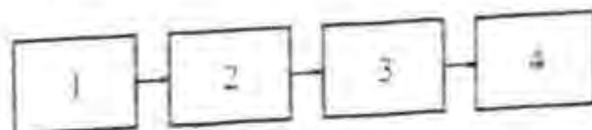
Рис. 4. Блок-схема програмної реалізації методу підрахунку фотонів: 1 — ФЕП; 2 — підсилювач; 3 — швидкодіючий АЦП; 4 — програма обробки і підрахунку.
