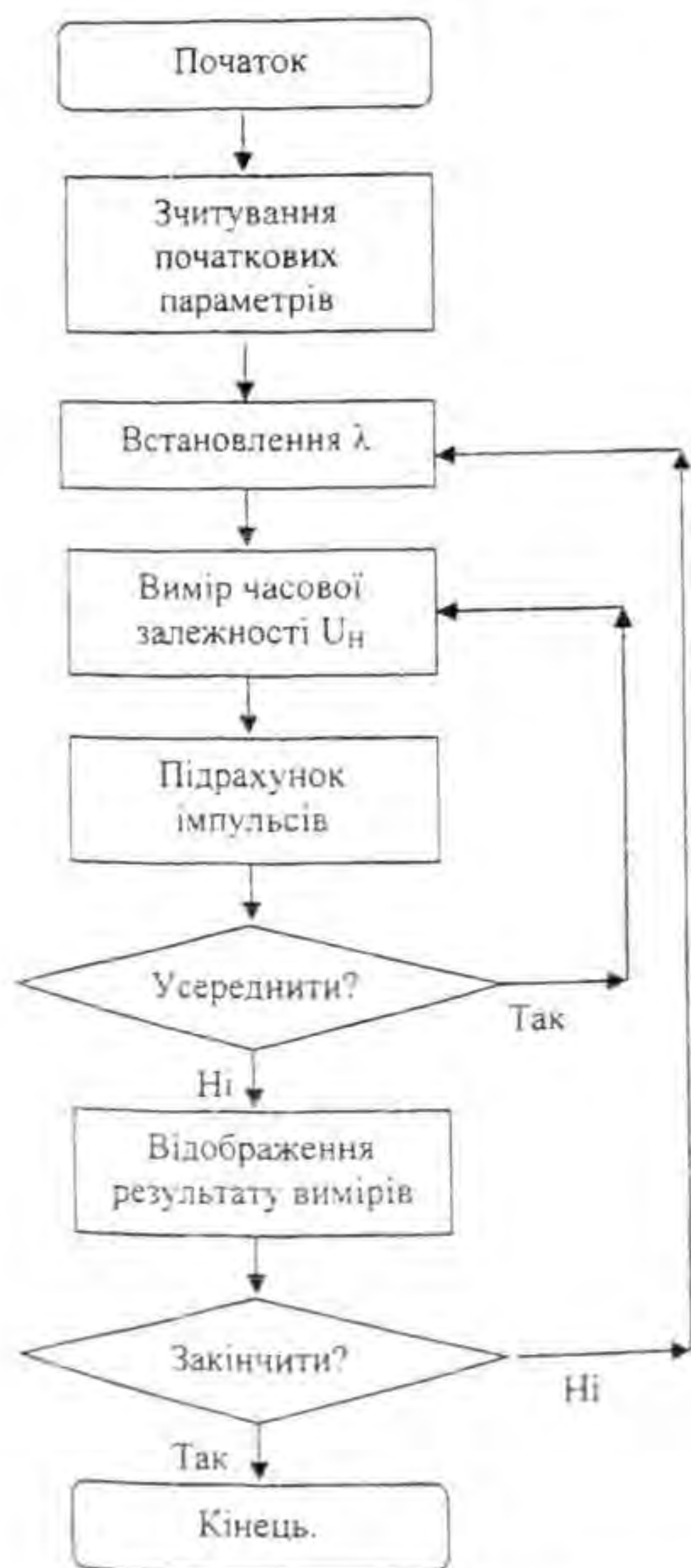
Рис. 7. Блок-схема програми для вимірювання спектральної залежності електролюмінесценції об'єкту методом підрахунку фотонів.
