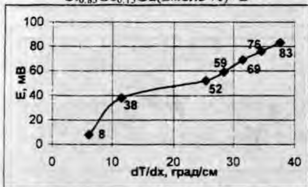
Рис. 12 Результати виміру термо-ерс в сплаві \text{Si}_{0.85}\text{Ge}_{0.15}\text{Ga}(2\text{моль \%})+\text{B}
