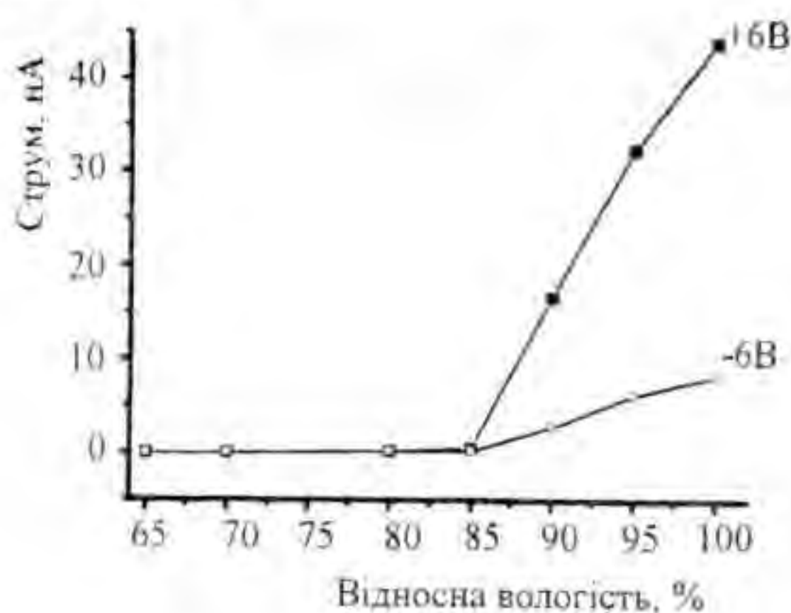
Рис. 4. Залежність величини електричного струму через зразок пресованого полікристалічного гуаніну від відносної вологості при постійній напрузі на зразку +6 та -6 В.
