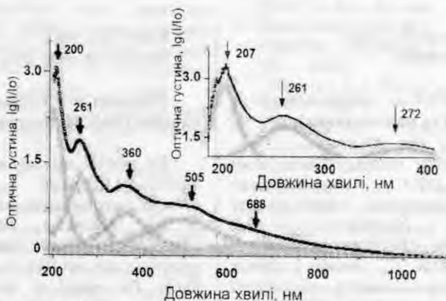
Рис. 1 Типові спектри абсорбції ДНК/ C_{60} супрамолекул у водному флюїді (співвідношення об'ємів відповідних суспензій – 1:1): спектр в діапазоні 200-1000нм відповідає водному флюїду після приготування; спектр в діапазоні 200-400нм - після 60 годин інкубації (наведено на вставці). Спектри апроксимовані набором Гауссін. Спектри зареєстровано при кімнатній температурі UV-vis-NIR спектрофотометром Jasco V-570.
