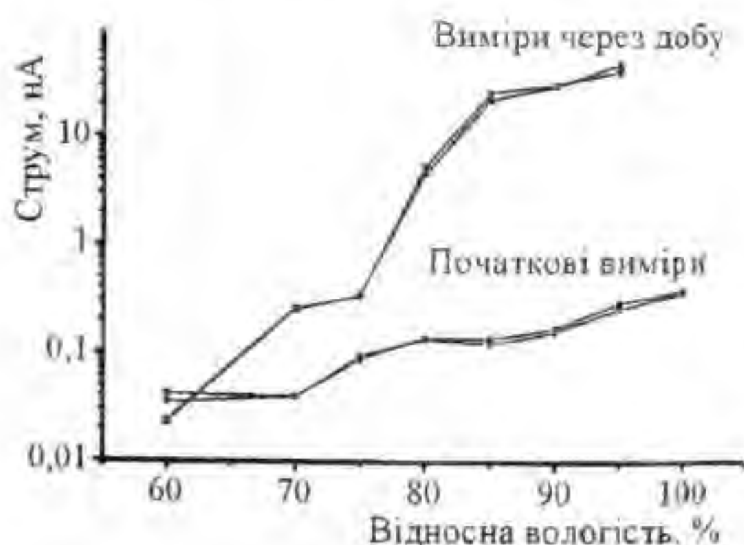
Рис. 6. Залежність величини електричного струму через зразок пресованого полікристалічного аденіну від відносної вологості.
