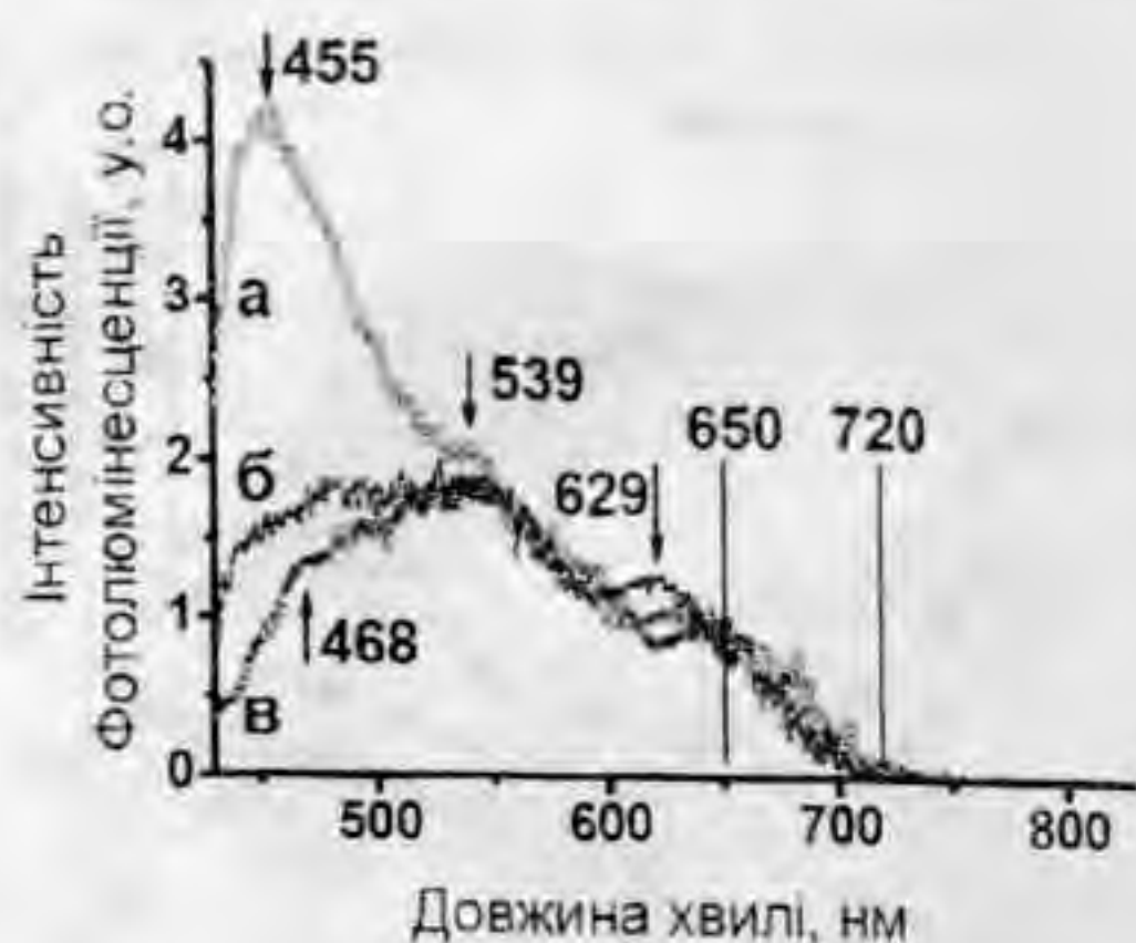
Рис. 4 Типові фотолюмінесцентні спектри іммобілізованих кисневими групами C_{60} молекул у водному флюїді, зареєстровані при довжинах хвиль збуджуючого світла 348, 394 та 408нм (лівий рисунок, відповідно криві а, б, в) та набір фотолюмінесцентних спектрів, зареєстрованих при довжинах хвиль збуджуючого світла в діапазоні 270-420нм з інтервалом 6нм (правий рисунок, трьохвимірне зображення, довжина хвилі збуджуючого світла – довжина хвилі фотолюмінесценції – інтенсивність фотолюмінесценції). Спектри зареєстровано при кімнатній температурі спектрофотометром Perkin Elmer LS 55.
