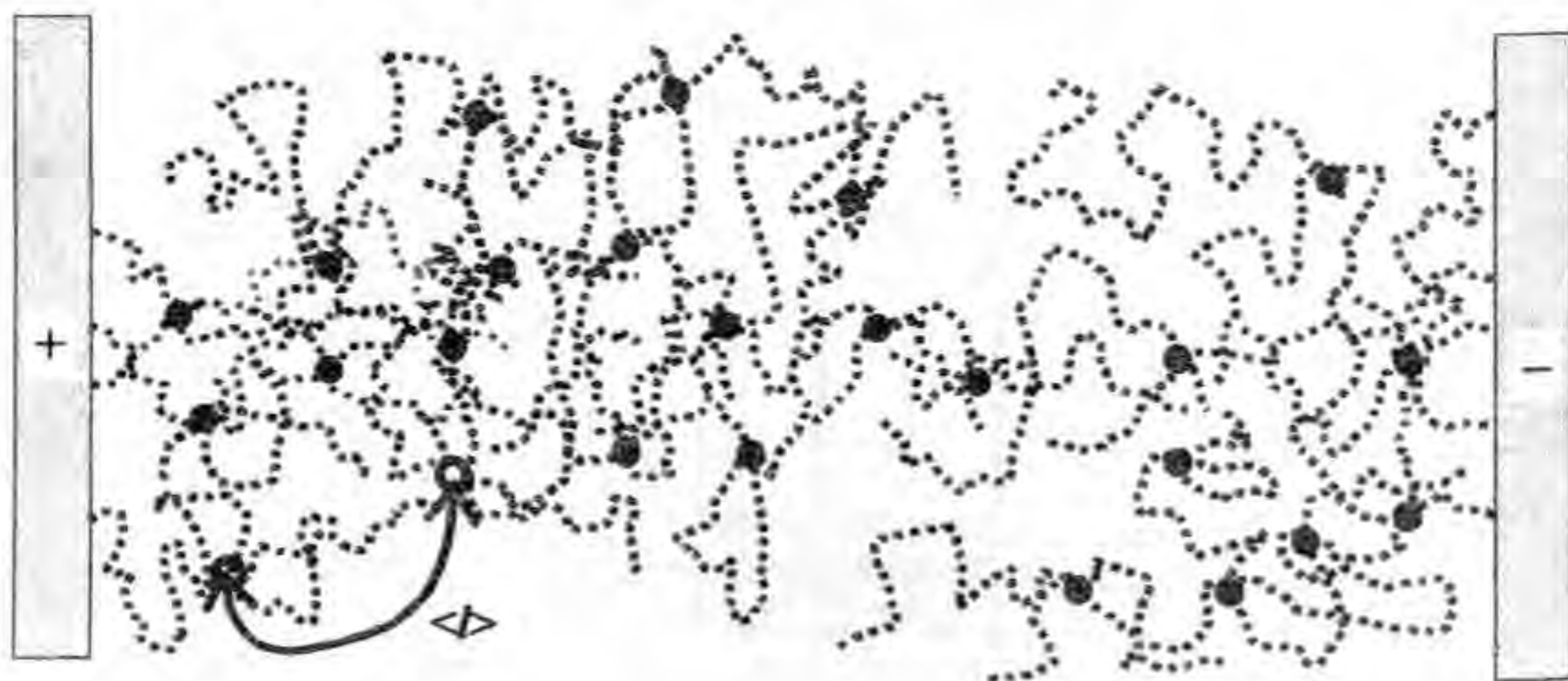
Рис. 6. Провідний кластер – система, яка виникає з мокрих піщинок в малозволоженому піску між двома плоскими електродами (схематичне представлення). Жирними точками показано вузли-розгалуження кластера провідності. \langle l \rangle – середня довжина ланцюжка провідності між двома сусідніми вузлами кластера. Виділена світлим смуга показує, як у тонкому шарі піску зменшується можливість для самошунтування гілок кластера провідності
