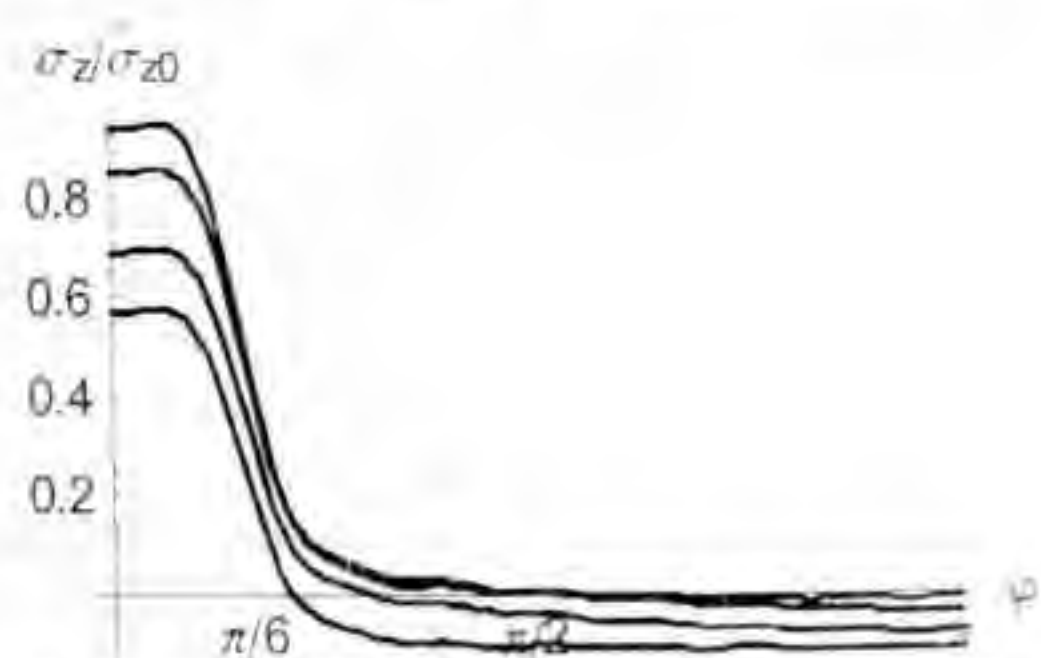
Рис. 6. Кутовий розподіл осьових напружень на внутрішній стінці для моментів часу t=0.01, 0.1, 1, 5
