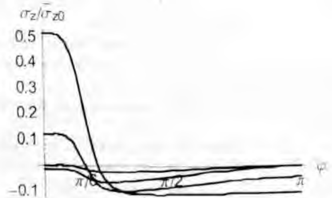
Рис. 7. Кутовий розподіл осьових напружень на зовнішній стінці для моментів часу t=0.01, 0.1, 1, 5
