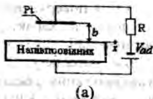
Рис. 1. Схема розташування зразка і пробного електрода при вимірюваннях за методом Кельвіна (а) і еквівалентна схема кола динамічного конденсатора (б).
