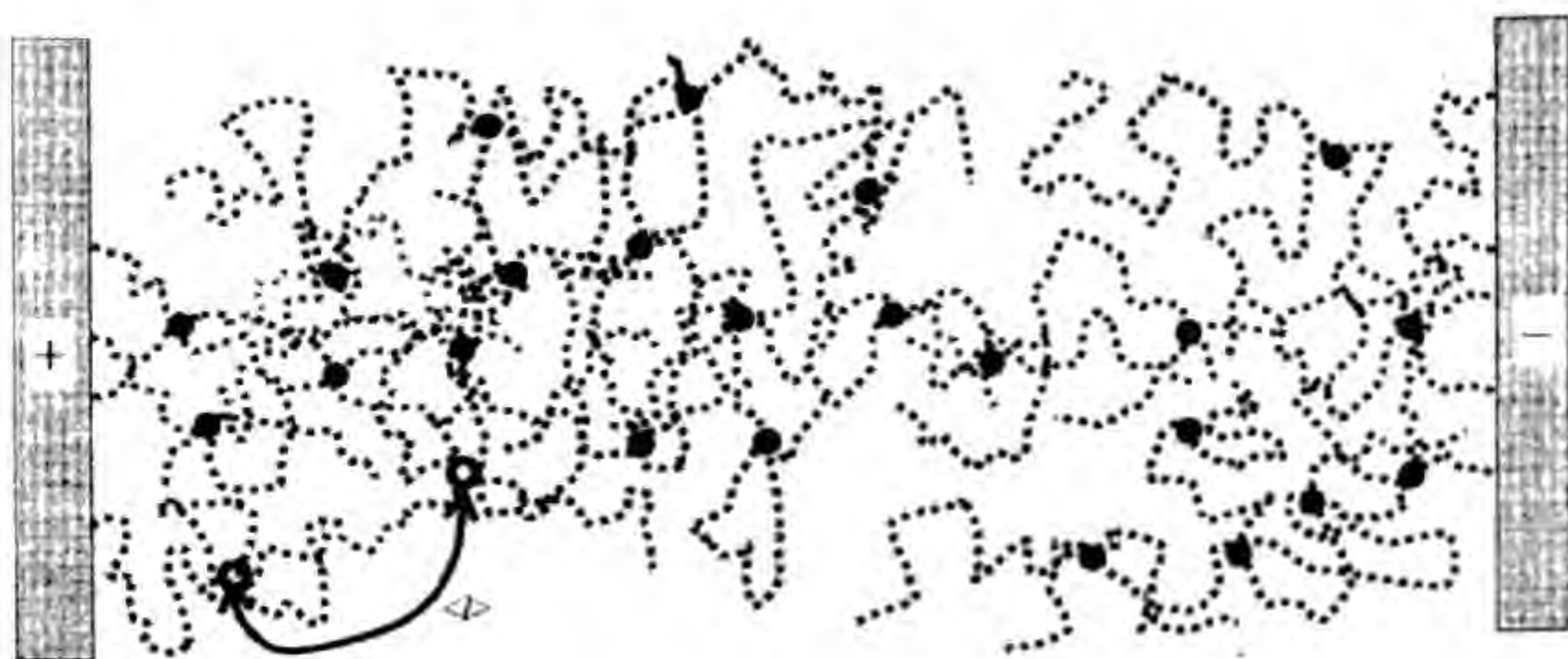
Рис. 6. Провідний кластер – система, яка виникає з мокрих піщинок в малозволоженому піску між двома плоскими електродами (схематичне представлення). Жирними точками показано вузли-розгалуження кластера провідності. \langle l \rangle – середня довжина ланцюжка провідності між двома сусідніми вузлами кластера. Виділена світлим смуга показує, як у тонкому шарі піску зменшується можливість для самошунтування гілок кластеру провідності.
